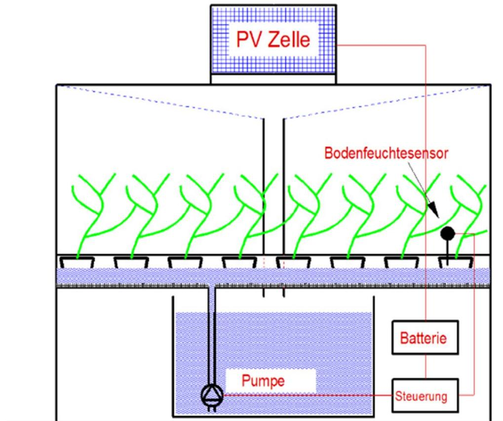
Wenn der Bodenfeuchte-sensor (das Tensiometer) registriert, dass die Pflanzerde zu trocken ist, sendet er ein Signal an die Steuerungseinheit und ein Bewässerungszyklus beginnt.
